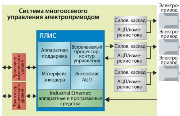
Рис. 2. Реализация драйвера электропривода на кристалле позволяет минимизировать стоимость материалов и уменьшить форм-фактор системы
